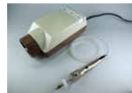
〈試作完成品〉種子・細胞移動用ピンセット(100μ単位の種子を空気圧で移動させる器具)
