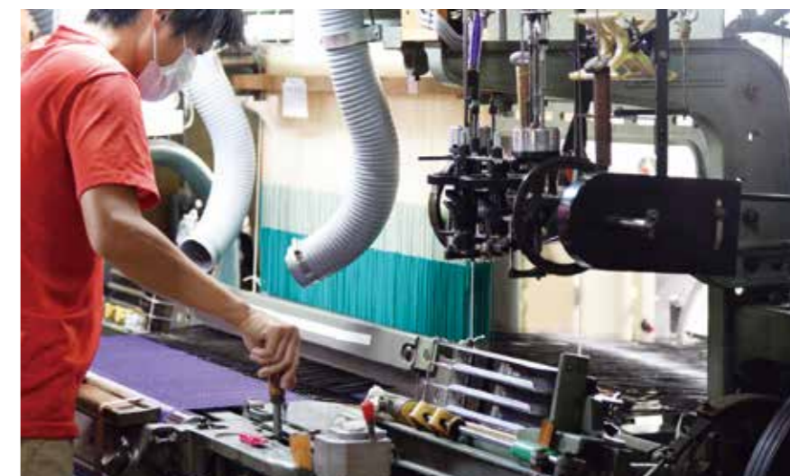
12台ある織機のうち4台で炭素繊維の織物が織られる。105cm幅の織機はネクタイを織っていたものを改良した。
