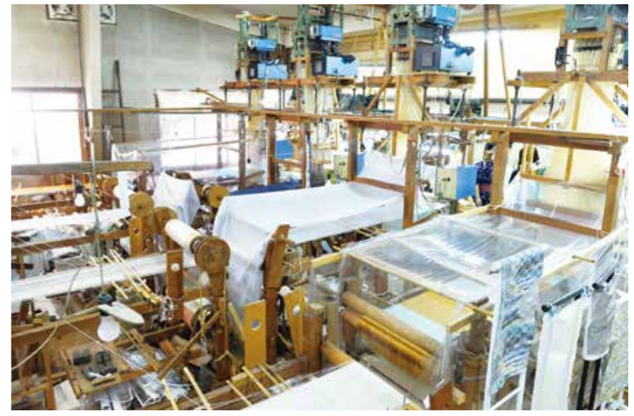
紋紙やフロッピーディスクとジャカードによって模様を織り出す。織機には先人の知恵と経験が詰まっている。
